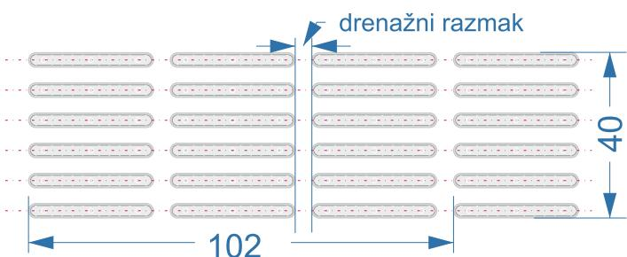
Montiraju se na čvrste i glatke podlove (mermer, keramika, liveni podovi, granit, brušene terace...) lepljenjem elemenata uz pomoć aluminijumskih šablona 1000x400mm (laserski sečeni AlMg3).
